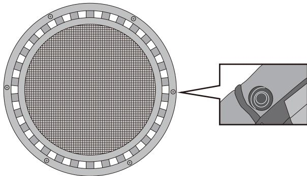
4) G.エンドキャップ(6個)を外し、F.脚を垂直に本体ネジ部に差し込みます。ゆっくりとネジを切らないように回していきます。
