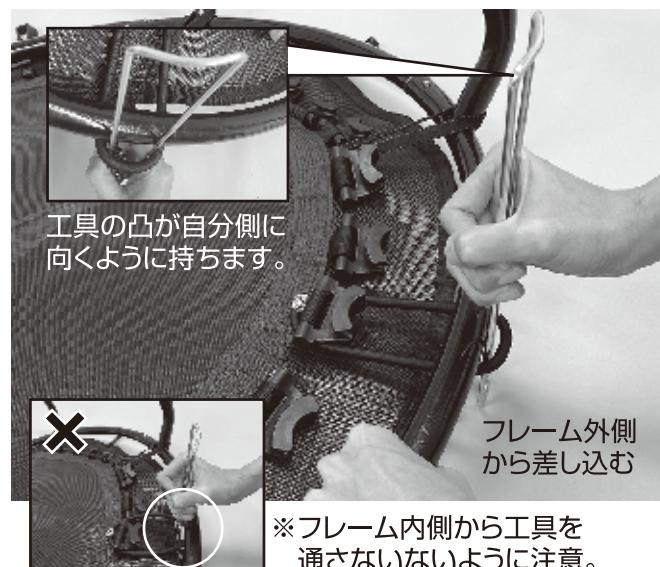
14)組立工具の先端を固定ガイド溝に引っ掛けるように合わせます。
