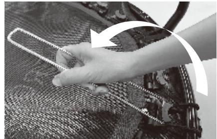
14) すべてのゴムチューブの取り付け後、ベルト(外)6本を固定ガイド溝のゴムチューブに重ねて引っ掛け、組立終了です。
